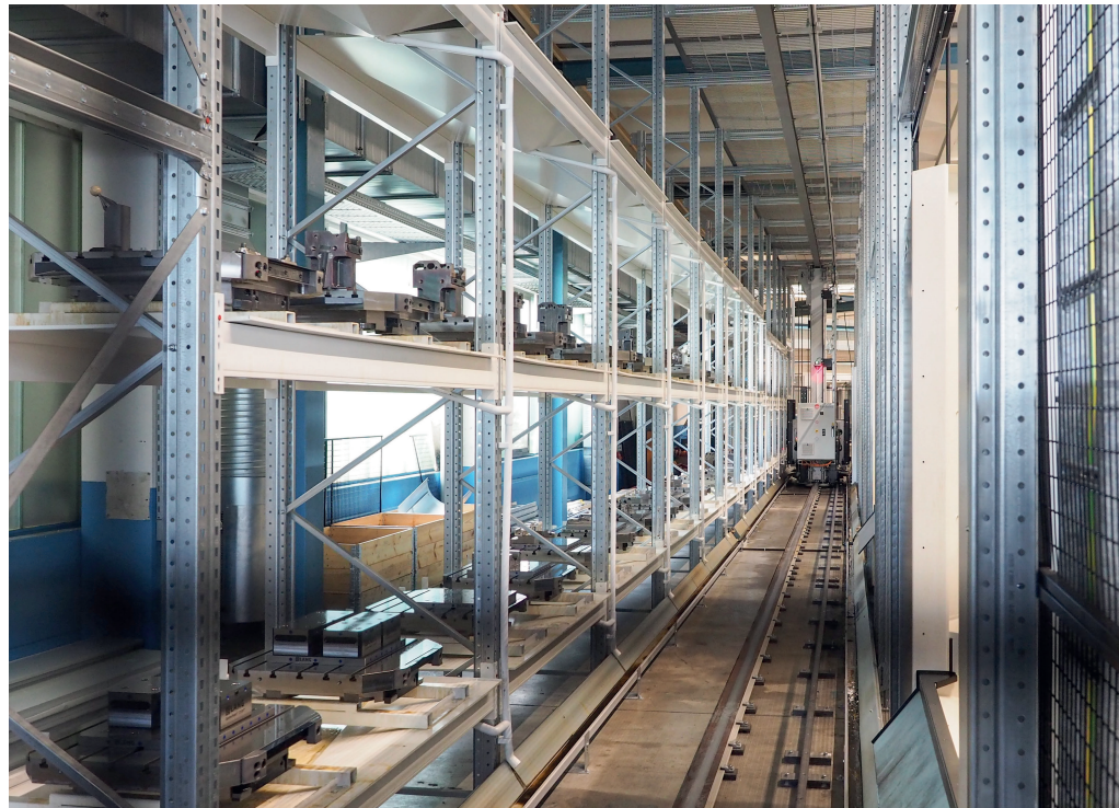
Automatisiertes Palettiersystem: Ein Roboter bestückt Bearbeitungszentren und drei Rüstplätze mit Aufträgen. © Hanser/Schröder
